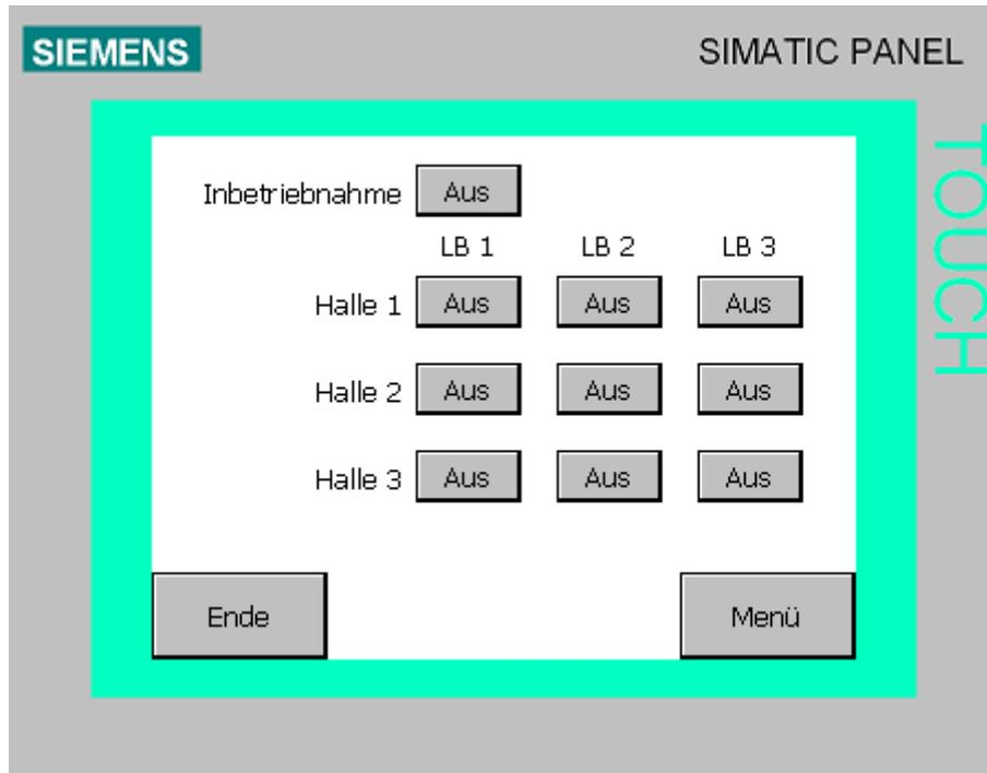
Zum Einmessen der Hallen können hier die Lichtbänder der Hallenteile unabhängig von der berechneten Beleuchtungsstufe separat eingeschaltet werden.
