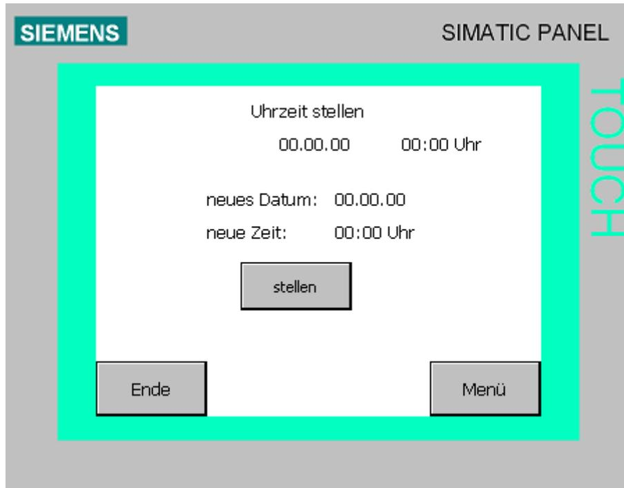
Angezeigt werden das aktuelle Datum und die Uhrzeit der Steuerung. Bei Ausfall des DCF-Signals kann das Datum und die Uhrzeit manuell vorgegeben werden und mit der Schaltfläche „stellen“ zur Steuerung übertragen werden.
